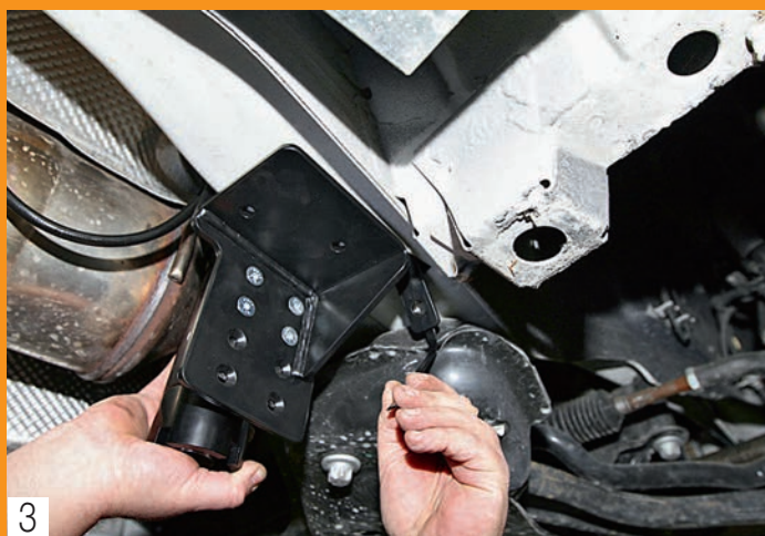
3. Le vérin avant est fixé sur son support en différents points, notamment par des vis et une bride. Cette dernière a la particularité de se glisser dans une cavité du châssis.
