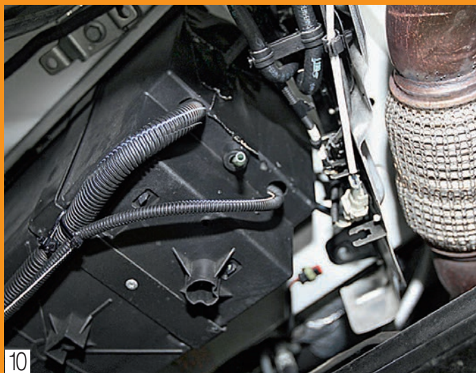
10. Les faisceaux d'alimentation 12 V et de commande de la pompe passent à l'intérieur de l'habitacle par le bac de batterie.
