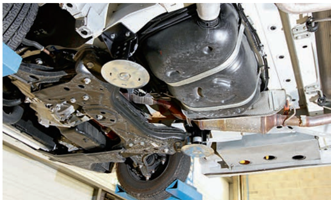
Logés derrière l'essieu avant, les vérins s'intègrent parfaitement dans leur environnement. Leur garde au sol est inférieure à celle du point le plus bas du véhicule.
