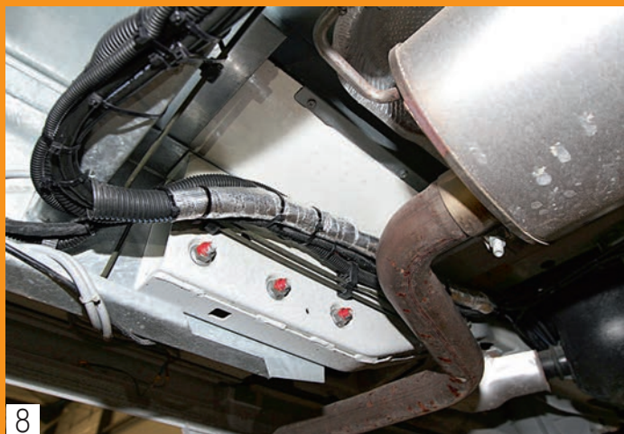
8. Une bande de protection thermique est appliquée sur les faisceaux électriques et autres flexibles lorsqu'ils passent à proximité de l'échappement.
