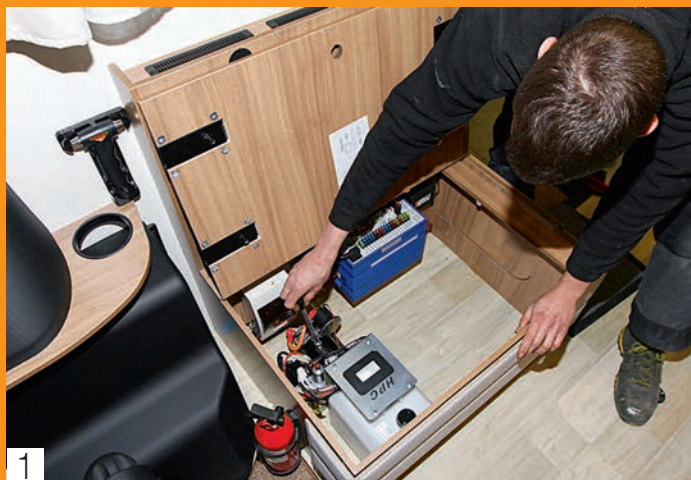
1. Le choix de l'emplacement de la pompe est fonction de certains critères, dont l'accès à la commande manuelle de la pompe et la facilité pour passer les câbles et les flexibles hydrauliques.
