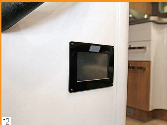
12. Le panneau de commande incluant le capteur de position s'installe sur un plan vertical à côté de la porte d'entrée.
