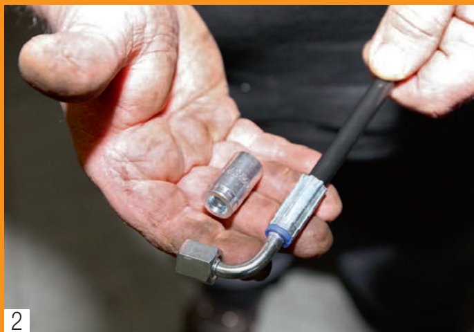
2. Les longueurs des conduites hydrauliques sont réalisées sur mesure. L'atelier de montage doit disposer d'une machine pour sertir les raccords sur le flexible.
