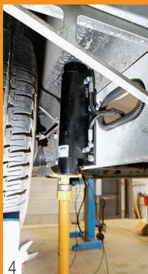
4. Le vérin arrière se place au plus près de l'essieu, en fonction de l'espace disponible.
