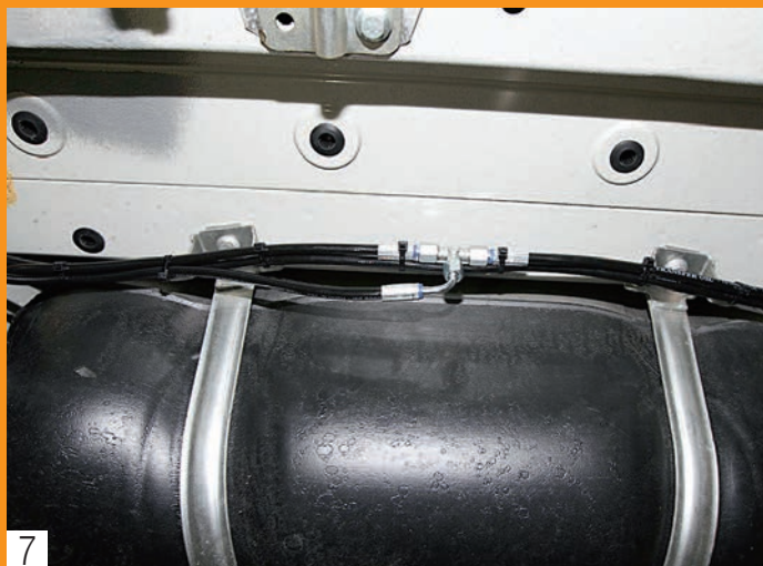
7. Le repli des quatre vérins est alimenté par un circuit unique, avec une pression maximale de 150 bars.
