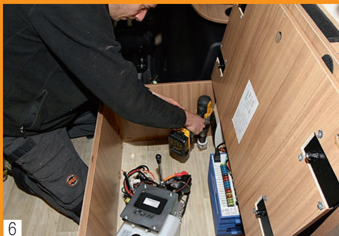
6. La pompe électro-hydraulique est systématiquement installée dans un coffre intérieur à partir duquel il sera facile d'utiliser la commande manuelle, en cas de dysfonctionnement de la commande électrique.
